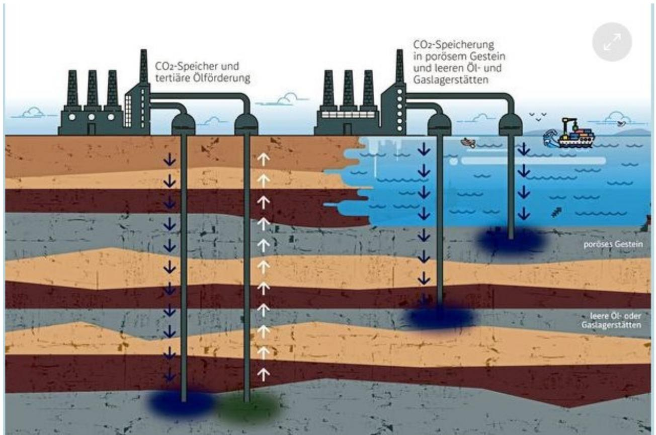
Verschiedene Varianten von Carbon Capture and Storage (CCS). Auch in der Ölförderung wird die Technik eingesetzt.
